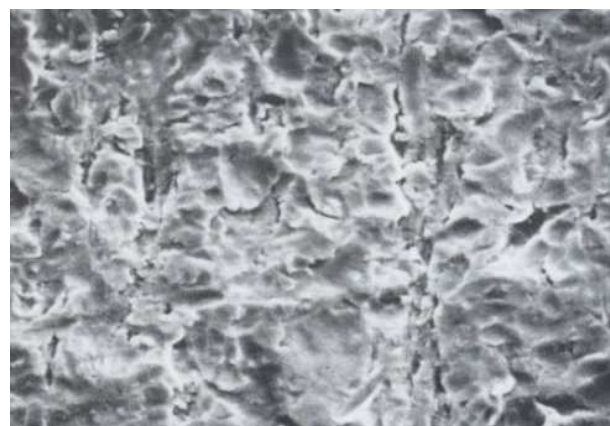
Powierzchnia miedzi po czyszczeniu strumieniem korundu (powiększenie 2500x) (© IS International Supplies s.r.l., Italy)
