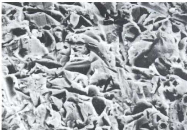
Powierzchnia miedzi po szcztokowaniu pumeksem (powiększenie 2500x) (© IS International Supplies s.r.l., Italy)
