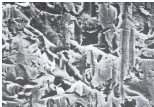
Powierzchnia miedzi po szcztokowaniu korundem (powiększenie 2500x) (© IS International Supplies s.r.l., Italy)
