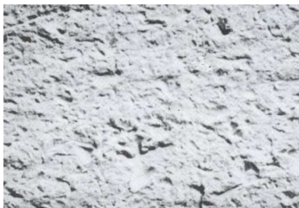
Powierzchnia miedzi po czyszczeniu strumieniem pumeksu (powiększenie 2500x) (© IS International Supplies s.r.l., Italy)
